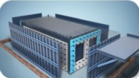
将钢筋保温板置入模具内
